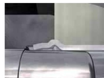
3. Die Kontur des Anschlusses wird durch die Geometrie der Werkzeuge bestimmt
