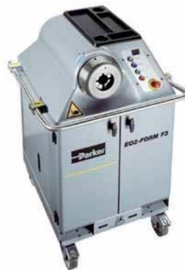
Das EO2-Form WorkCenter F3 arbeitet vollautomatisch. Lediglich ein Drittel der Arbeitsschritte werden beim Umformungsverfahren gegenüber dem Schweißen benötigt. So sind die Verbindungen leicht, schnell und sicher hergestellt.
