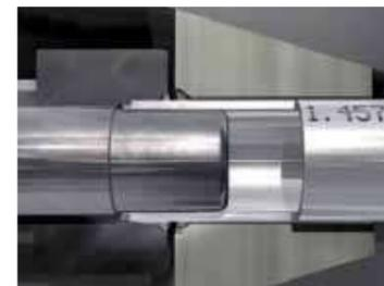
2. Das Rohr wird bis zum Anschlag in die Werkzeuge eingeführt
